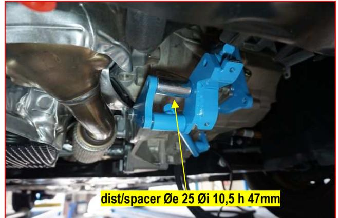
18. Montare la vite TE 10 x 45 + rondella relativa al puntone "H" (foto n. 19) e bloccare tutti i bulloni che fissano il supporto "L";
