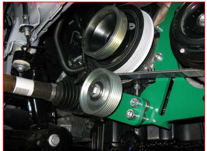
9. Montare tra il supporto “A” ed il supporto “C” il distanziale Øe 22 Øi 8,5 h 30mm con l’ausilio della vite TCEI 8 x 60 + rondella (foto n. 7);
