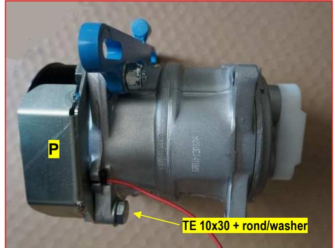
21. Montare il compressore come da foto n. 26 e n. 20 ed il puntone "N";
