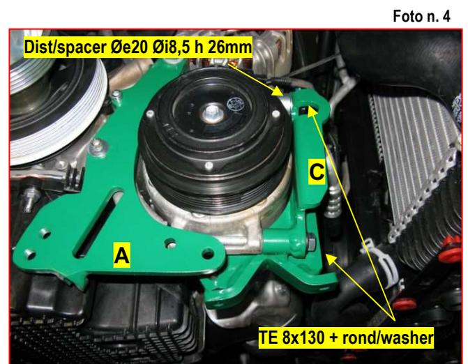
7. Montare il supporto “C” con le due viti TE 8 x 130 e rondelle e il distanziale h 26mm (foto n. 4);
