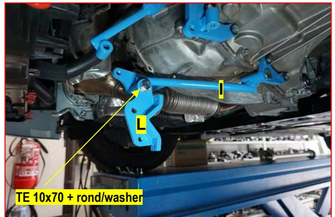
17. Montare la seconda vite TE 10 x 70 + rondella + distanziale h 47mm con il supporto “L” (foto n. 17 e n. 18);
